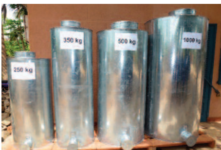
Photo 17 : Silos métalliques de diverses capacités
